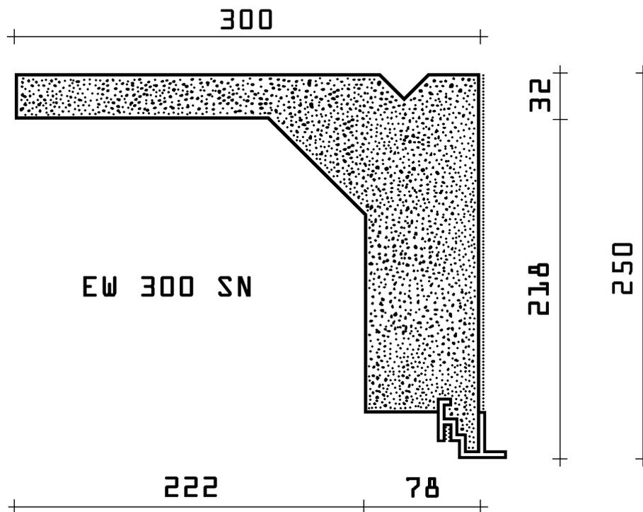
Serienmäßig haben alle Rolladenkästen der Typenreihe EW eine spezielle **Clip - Innenschiene** für den einfachen, schraublosen **EASY - CLIP - Deckelanschluss**, mit 15 mm Ausladung.
